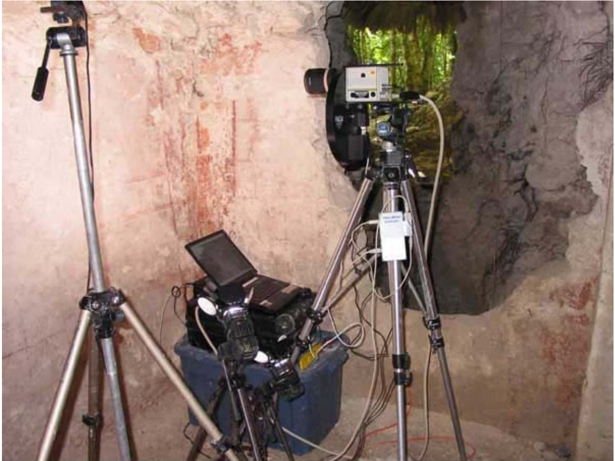
Figura 35. Vista de un equipo de representación de imágenes multispectrales instalado en el Cuarto 1 de la Estructura 1 de La Sufricaya, frente a las paredes del mural 1 y 3.
