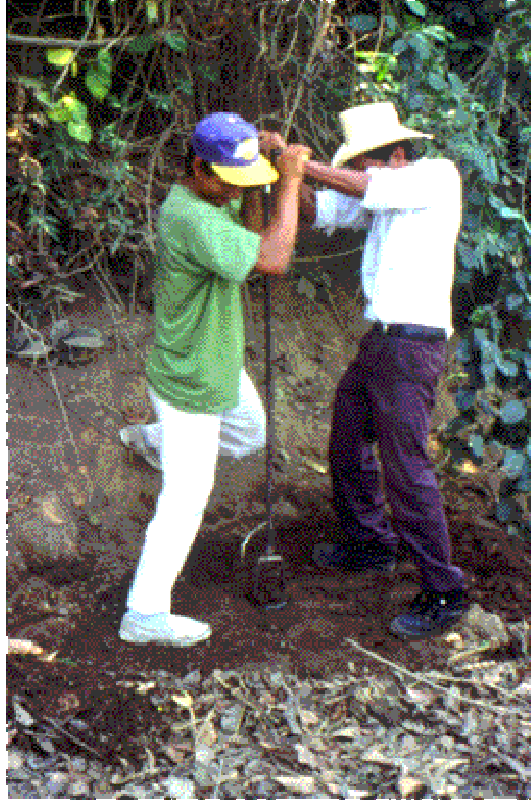
Figura 6: Enrique Urisas y Leonel Urisas hacen una demostración del uso de una draga para obtener muestras de arcilla.
