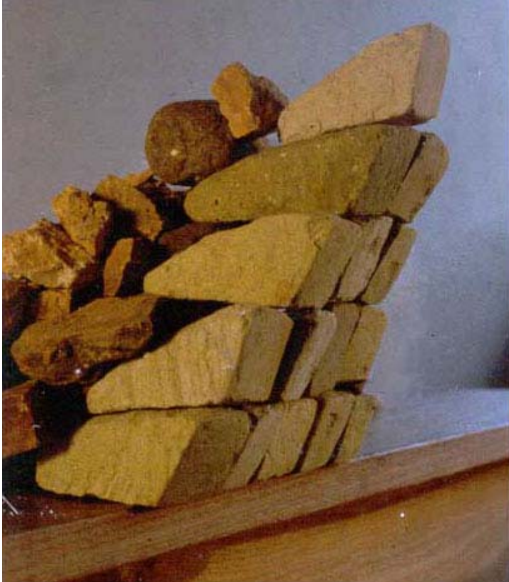
Foto 52. Copán, experimento: construcción a escala de bóveda sin aglutinante, octubre de 1986.
